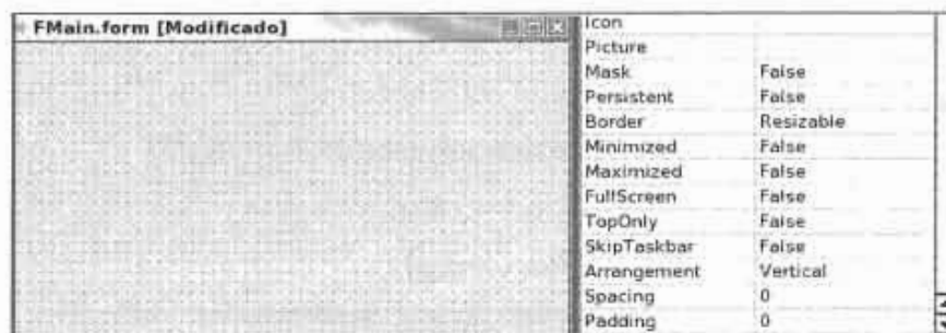
Figura 33. Formulario con la propiedad Arrangement a Vertical .
